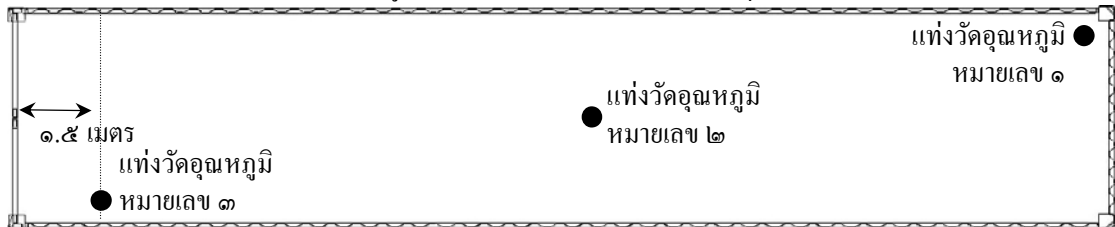
ภาพที่ ๑ ตำแหน่งการวางแท่งวัดอุณหภูมิผลไม้ภายในตู้ขนส่งสินค้าสำหรับการกำจัดศัตรูพืชด้วยความเย็นในระหว่างขนส่ง
